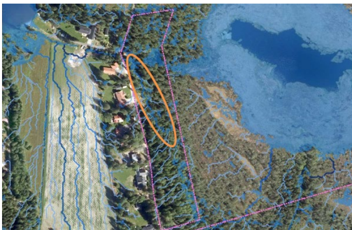
Figur 19. Avrinningsstråk och stående vatten i norra delen av området. Orange markerat är område där särskild hänsyn måste tas till rinnstråk. Källa: Sweco
