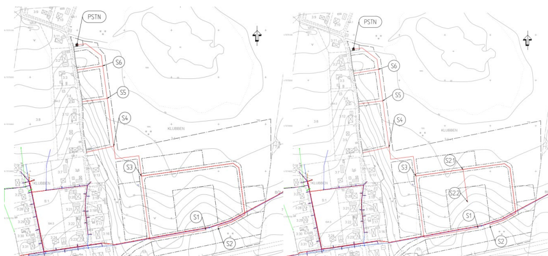
Figur 22. Förslaget ledningsnät för spillvatten, till vänster förslag med skola, till höger förslag utan skola/med bostadsfastigheter. Planområdet har minskats efter att utredningen genomförts. Källa: Sweco
