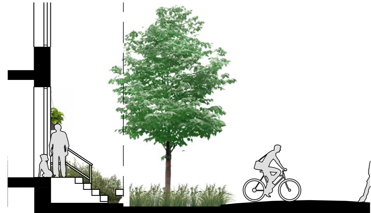
Typ C Denna uppbyggnad av frizon har en avsats vid dörren för att därefter leda ner till en yta i markplan. Hybridzonen möter gatans grönzon med ett högre "sittsteg" längs dess längd. Typ C behöver räcken på kortändarna.
